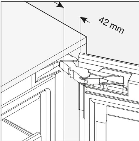
So wird ein umlaufender Abstand von **42 mm** zu den Vorderkanten der Möbelseitenwände eingehalten.
