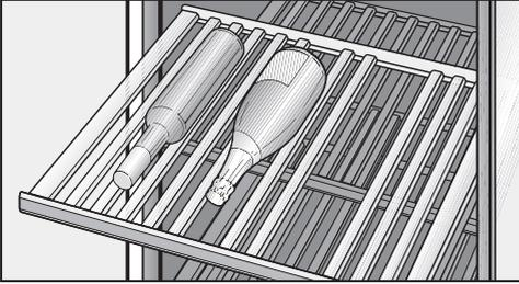
Die auf Auszugsschienen geführten Holzroste sind weit herausziehbar, so dass Sie die Weinflaschen bequem einlegen und wieder entnehmen können.
